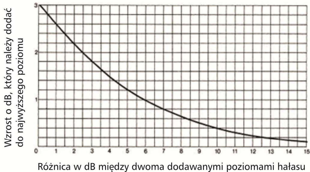
Wykres obliczania wzrostu dB dla dwóch źródeł hałasu
